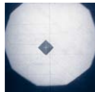
Vickersseindruck im Hellfeld Vickers indentation in the bright field
